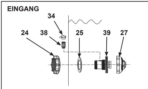
Wenn die Pumpe als Teil eines Pool-Sets gekauft wurde mit 38 mm Verbindungen/Schläuchen, sind die nachfolgend aufgeführten Armaturteile für den Zulauf enthalten:
