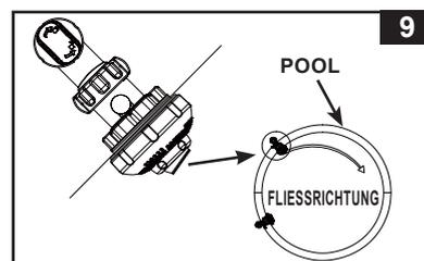
**HINWEIS:** Verschließen Sie das Luftstrahlventil (38) unter normalen Umständen, oder während die Pumpe läuft, nicht mit der Ventilkappe (34). Siehe "Anleitung zur Fehlerbehebung".
